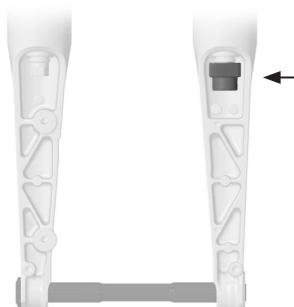
Tournez la molette de la détente en position fermée dans le sens des aiguilles d'une montre jusqu'à ce qu'elle se bloque. Puis tournez-la dans le sens inverse des aiguilles d'une montre en comptant le nombre de crans indiqué dans le tableau de la page précédente.
