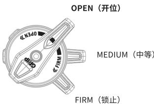
**3 位 Micro 调节旋钮**可用于进行骑行中的即时调节，以控制前叉的性能。使用 OPEN (开位)、MEDIUM (中等) 和 FIRM (锁止) 模式来精细调节压缩阻尼。
