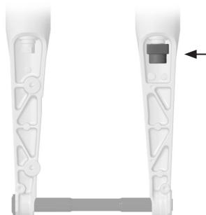
Drehen Sie den Zugstufeneinsteller in die geschlossene Position, d. h. bis zum Anschlag im Uhrzeigersinn. Drehen Sie ihn dann um die in der Tabelle auf der vorherigen Seite angegebene Anzahl Klicks gegen den Uhrzeigersinn.
