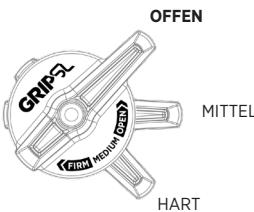
Der **3-Wege-Hebel** ermöglicht, schnelle Anpassungen vorzunehmen, um das Federverhalten der Gabel bei Veränderungen des Geländes anzupassen. Er ist für Einstellungen während der Fahrt vorgesehen. Verwenden Sie den OFFENEN Modus bei rauen Abfahrten, den MITTLEREN Modus bei unebenem Gelände und den HARTEN Modus zum effizienten Klettern.
