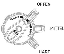
Der **3-Wege-Feineinstellhebel** ermöglicht schnelle Anpassungen des Federverhaltens der Gabel. Die Hebelpositionen zwischen dem OFFENEN, MITTLEREN und HARTEN Modus ermöglichen die Feinabstimmung der Druckstufendämpfung.
